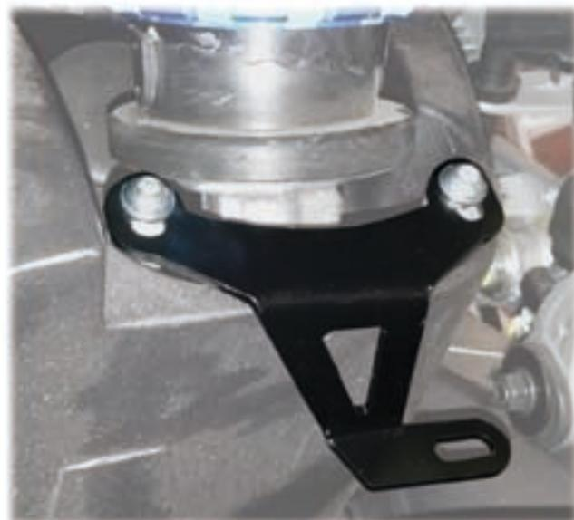
ENLEVEZ LE PROTEGE CHAINE ORIGINAL ET LES 2 BOULONS DE L'AMORTISSEUR ARRIERE. UTILISER LES 2 ENTRETOISES POUR FIXER LA FIXATION SPECIFIQUE COMME SUR LA PHOTO. ENSUITE INSTALLER LE GARDE BOUE COMPLET ET FIXER LE SUR LES TROUS DU BRAS OSCILLANT. UTILISER LA RONDELLE EN CAOUTCHOUC ENTRE LE SUPPORT ET LA PARTIE ABS DU GARDE BOUE POUR ABSORBER LES VIBRATIONS.
